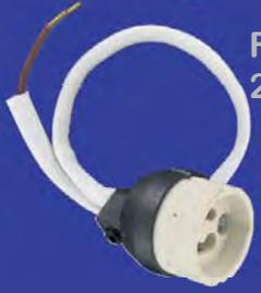
Fassung GU/GZ 10 für HV Halogenlampen, Fassungsstein Ø 28mm, mit 250mm doppelt isolierter Anschlußleitung und integrierter Zulentlastung
